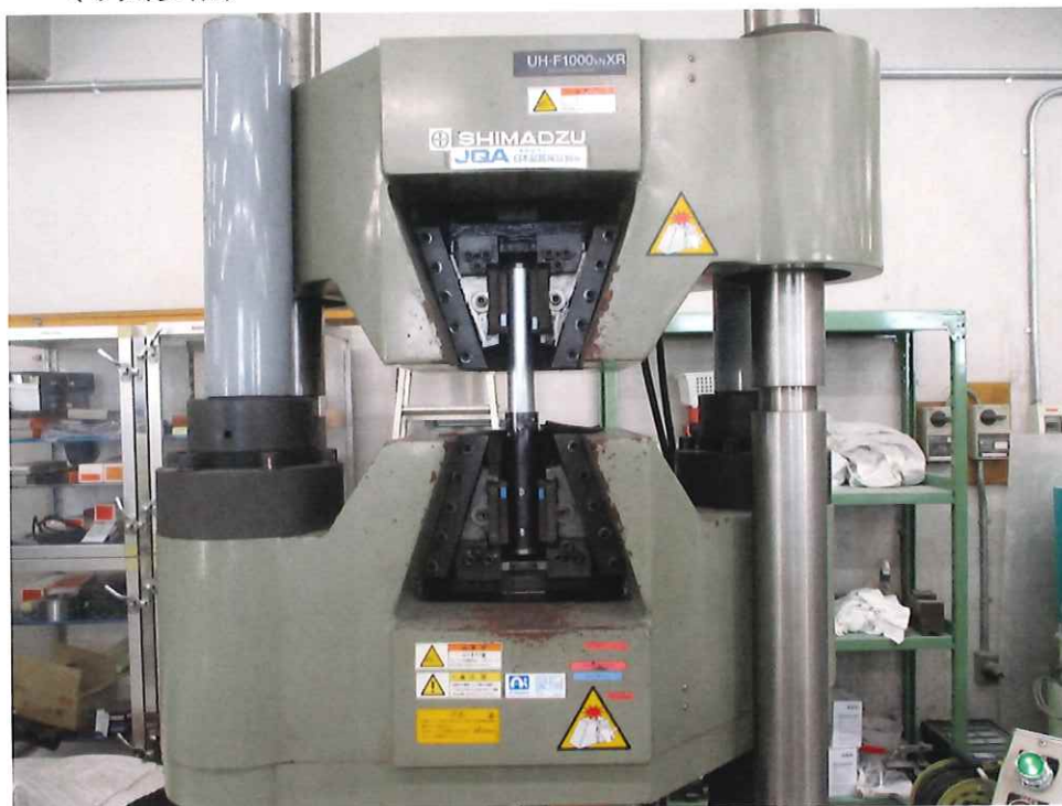
写真:試験品取り付け状況
