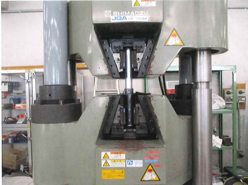
写真：試験品取り付け状況
