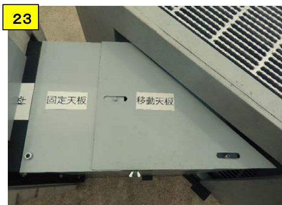
移動天板を固定天板と長辺移動の天板受けの ボルトに通し添え置く
