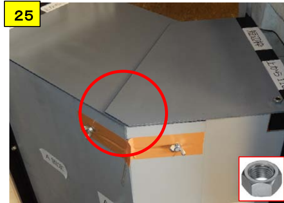
出っ張りが無い事を確認後、それぞれの天板をナットで固定する
