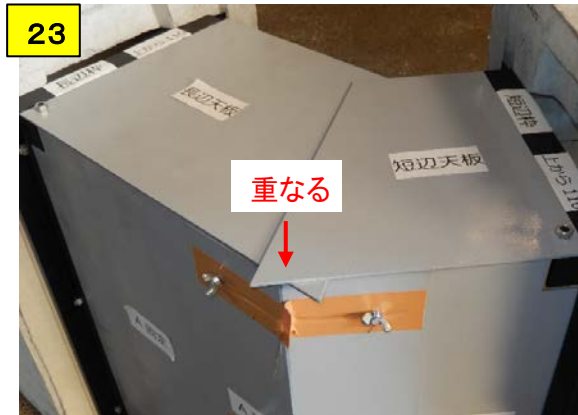
短辺天板と長辺天板をそれぞれの枠のボルトに一旦差込み添え置く 注) 天板は必ず重なり出っ張ります
