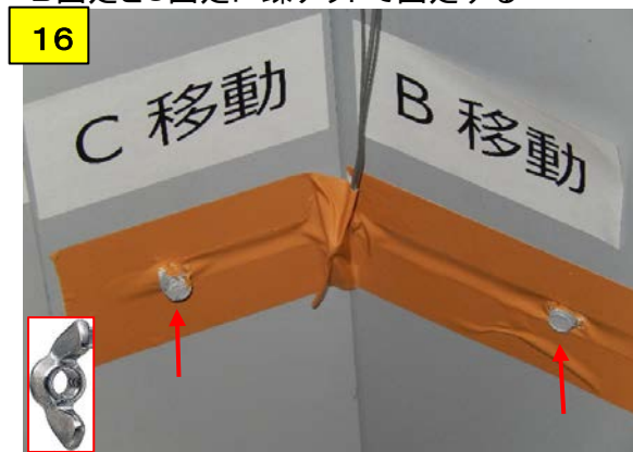
B移動・C移動をB固定・C固定に固定する場合はボルトでガムテープを突き破る
